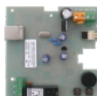
plošná doska s konektorom USB a 3 pin konektorom 0012017003
