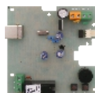
plošná doska s konektorom USB a Bluetooth modulom 0012018001 (RAK BLUE)
